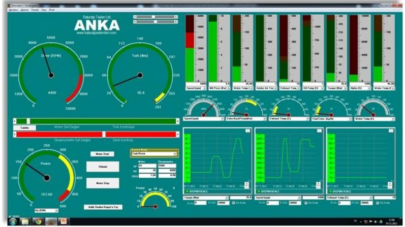
Motor Test Odası Kontrol, İzleme ve Raporlama Sistemi
